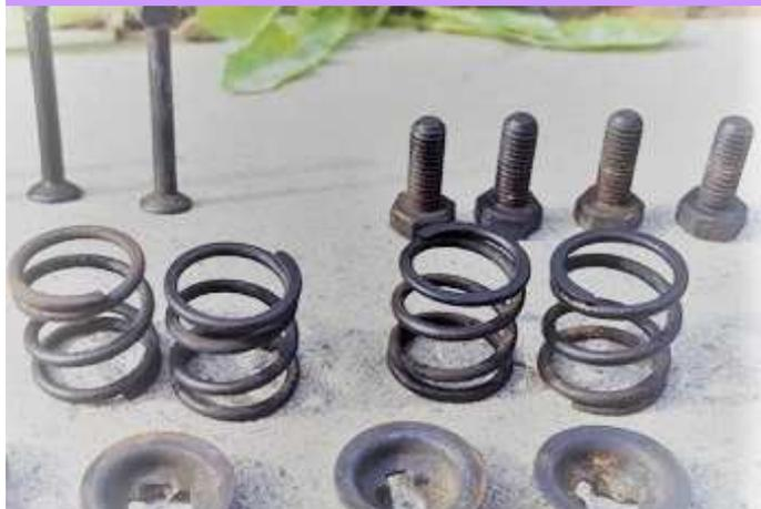
Le procédé de brunissage à température ambiante est une succession simple de trempés, qui peut-être réalisée dans tous les ateliers. Ce procédé ne modifie pas le dimensionnel des pièces et permet d'obtenir une coloration noire uniforme sur les surfaces usinées, les filetages, dans les trous aveugles, etc...
